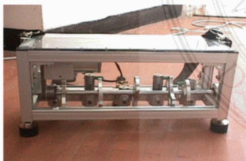
Il generatore è un dispositivo costituito da cinque martelli d'acciaio di peso 500 g, di forma cilindrica, disposti in linea retta, che cadono perpendicolarmente sulla superficie in prova, da una altezza di 40 mm per forza di gravità.
